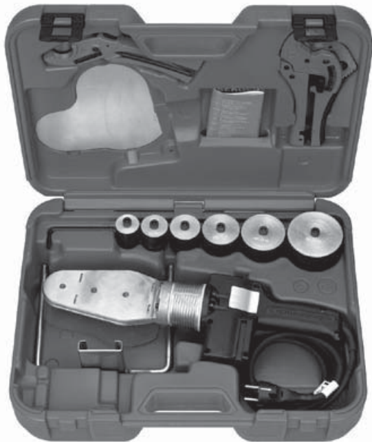
Abb. 17 Aufbewahrung des Muffenschweißgerätes
